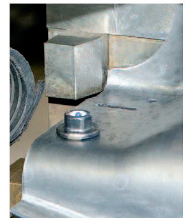
a výstupkové přivařované matice pro
